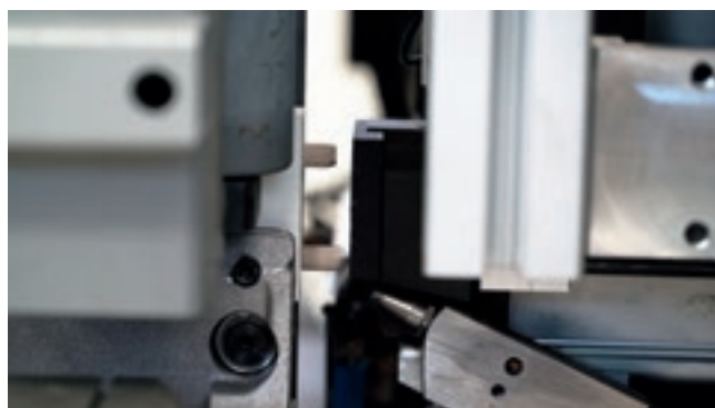
Устройство для управления впрыском клея и забивкой шантов с запатентованной системой замены инструмента.
